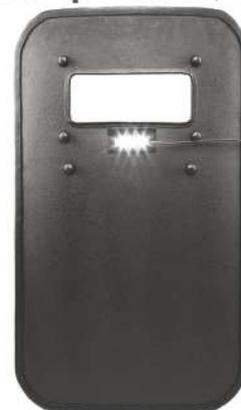
Bouclier balistique léger norme fédérale NIJ-STD-0108.01 niveau IIIA. Système de fixation avant-bras. Poids : 8,61 kg. Epaisseur du bouclier : 0.3 cm. Avec ou sans fenêtre (option). Option : Lampe B30 Led 1200 lu avec mode stroboscopique (FOX-480-331).
