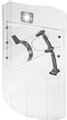
Bouclier anti-émeutes transparent tenue à une ou deux mains. Forme frontale en V contre les chocs latéraux. Polycarbonate extrêmement résistant. Epaisseur : 3 mm ou 5 mm. Poids : 3.5 kg. Option : Lampe R40 (FOX-700-331) 650 Lu, plusieurs modes dont strobe.
